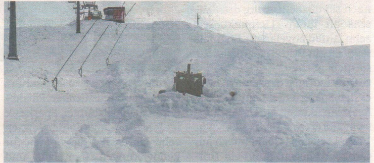
Das Schneedepot wurde von der Isolierung befreit und der Schnee in einer Schicht von 40 Zentimetern dann auf der 700 Meter langen und 60 Meter breiten Piste aufgebracht.
