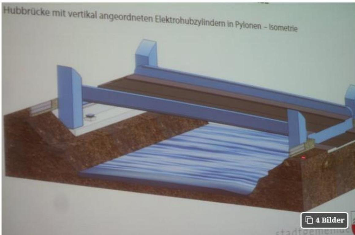
Eine Skizze der Brücke. Sie wird im Herbst errichtet, der Hubmechanismus in den Ecken wird im Frühjahr eingebaut. (Foto: Land Salzburg / Repro Nothdurfter)
